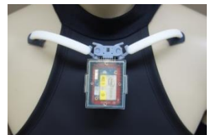
関節角度を計測し、「胸をはる」 「肩をすくめない」を評価する機構
