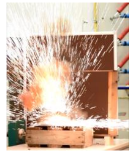
金属の溶融 (雷インパルス耐電流試験)
